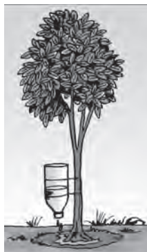
Riego por goteo con botellas plásticas
