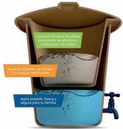
Imagen de ecofiltro tomada de https://goo.gl/images/4KAvQV con fines didácticos exclusivamente
